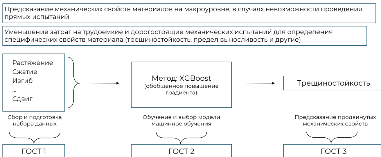
Рис. 1. Применение методов машинного обучения для повышения точности оценки свойств материалов по результатам косвенных измерений
