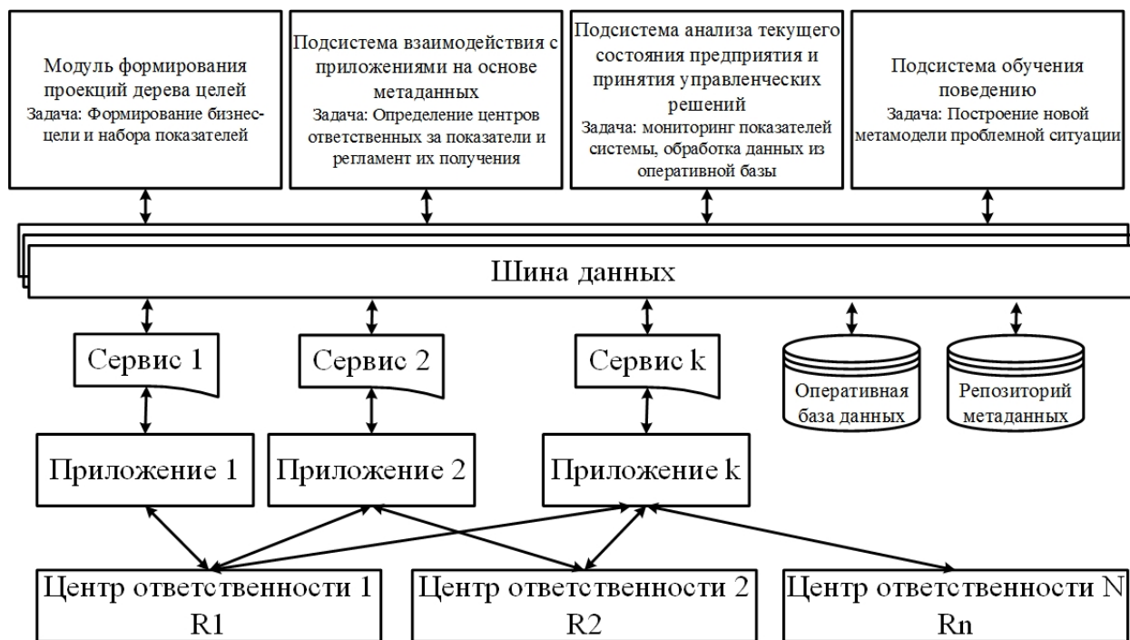
Рис. 4. – Структурная схема интегрированной информационной системы, обеспечивающая свойство поведения, где k – количество сервисов и приложений в ИС, N – количество центров ответственности
